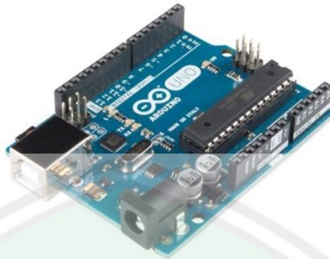
Gambar 2.3 Arduino Uno (Simanjutak, 2013)
