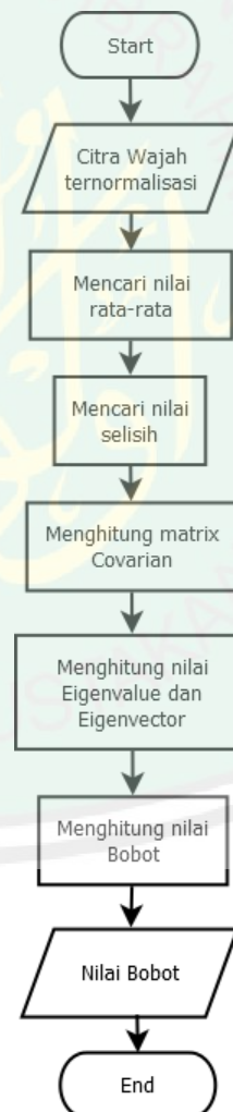
Gambar 3.8 Flowchart proses menghitung bobot
