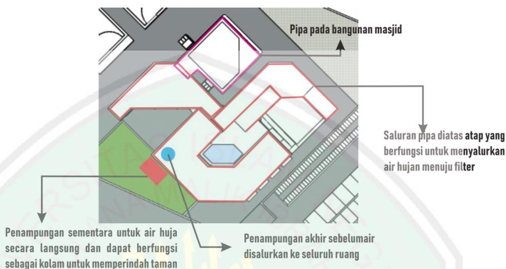
Gambar 4.41 analisis saluran air pada atap
