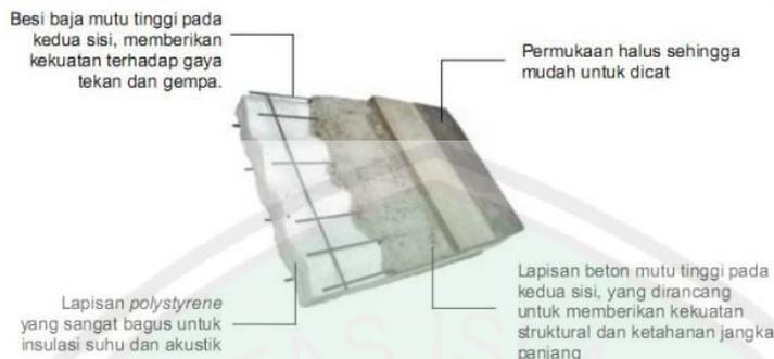
Gambar 4.39 analisis struktur dinding
