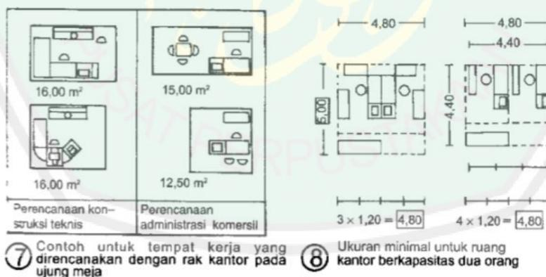
Gambar 2. 36 Standar tempat kerja & standar kantor kapasitas dua orang
