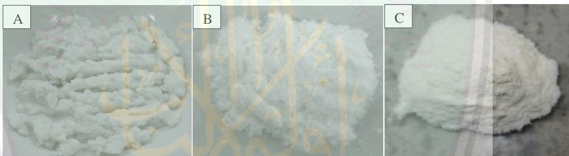
**Gambar 5. 10** Proses sintesis CMC-Na A) CMC-Na sebelum dioven, B) CMC-Na sesudah dioven, dan C) CMC-Na standar
