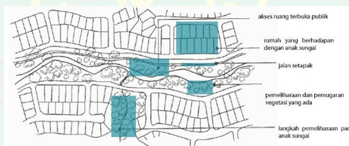
Gambar 2.12 Sistem penataan bangunan dengan menggunakan *water sensitive design*
