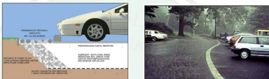
Gambar 2.34 sistem *permeable paving* pada kantong parkir (sumber: peraturan menteri pekerjaan umum no.12 tahun 2008)
