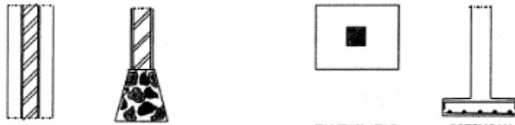
Gambar 4. 26 Tampak dan potongan pondasi menerus batu kali (kiri), tampak dan potongan pondasi setempat (kanan)
