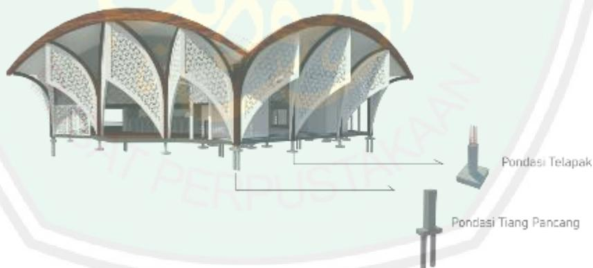
Gambar 6. 220 Detail pondasi bangunan masjid
