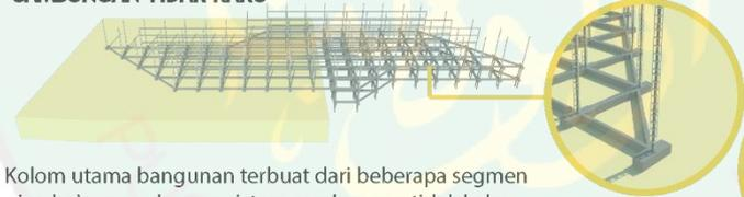
Kolom utama bangunan terbuat dari beberapa segmen pipa baja yang dengan sistem sambungan tidak kaku untuk mengantisipasi potensi terjadinya gempa dan terpaan angin yang kuat yang dapat merusak struktur bangunan
