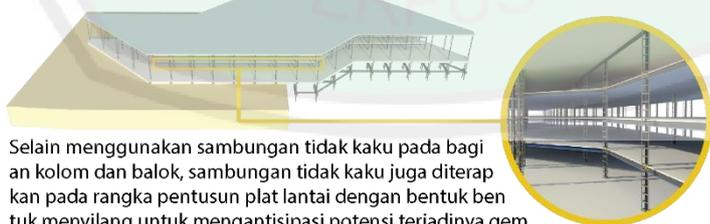
Selain menggunakan sambungan tidak kaku pada bagian kolom dan balok, sambungan tidak kaku juga diterapkan pada rangka penusun plat lantai dengan bentuk ben tuk menyilang untuk mengantisipasi potensi terjadinya gempa dan terpaan angin yang kuat yang dapat merusak plat lantai
