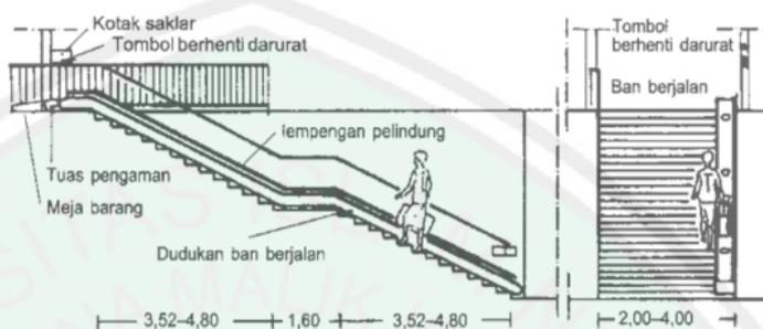
Gambar 2.20. Potongan eskalator
