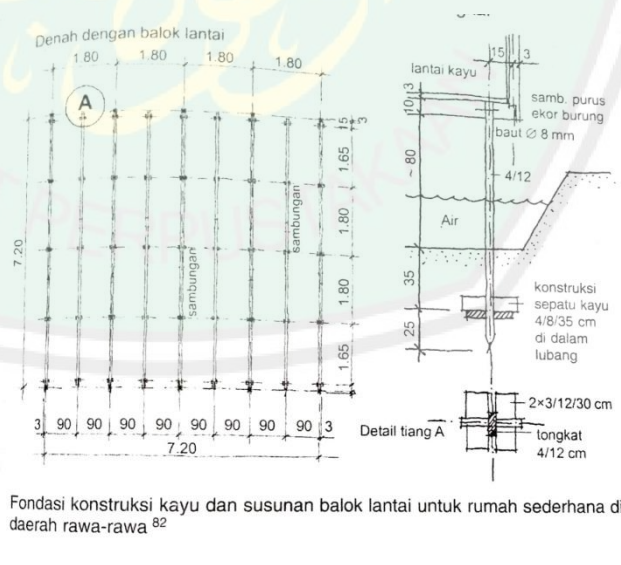
Gambar 2.26 fondasi konstruksi kayu dan susunan balok lantai Sumber : Frick, H. (2019). Arsitektur Ekologis
