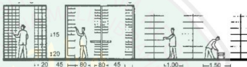
Gambar 2.61 Standart Ukuran Rak Penyimpanan
