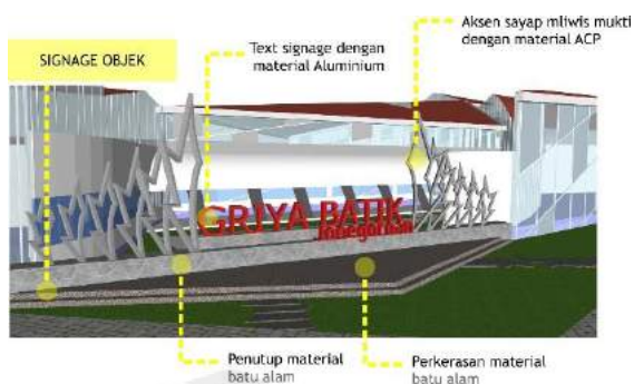
Gambar 6.35 Detail Lanskap Signage
