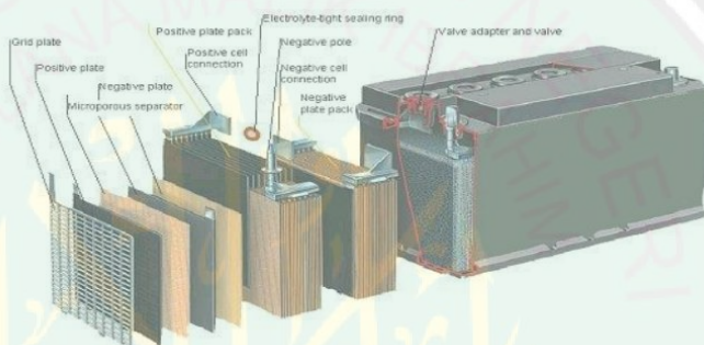
Gambar 2.35 Baterai/Aki sebagai penyimpan energi listrik (Sumber: https://core.ac.uk/download/pdf/25489720.pdf )
