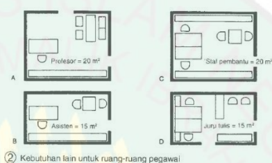
Gambar 2.9 Ruang pegawai pada kantor
