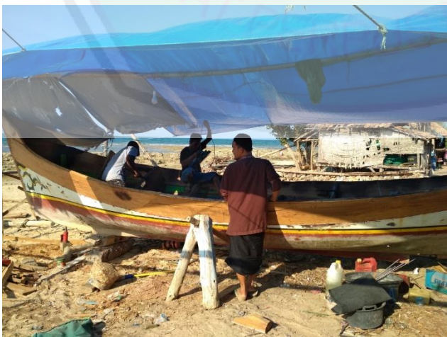
Gambar 8 : Perbaikan Kapal Motor
