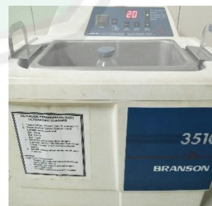
Gambar 8. Proses ekstraksi ultrasonik
