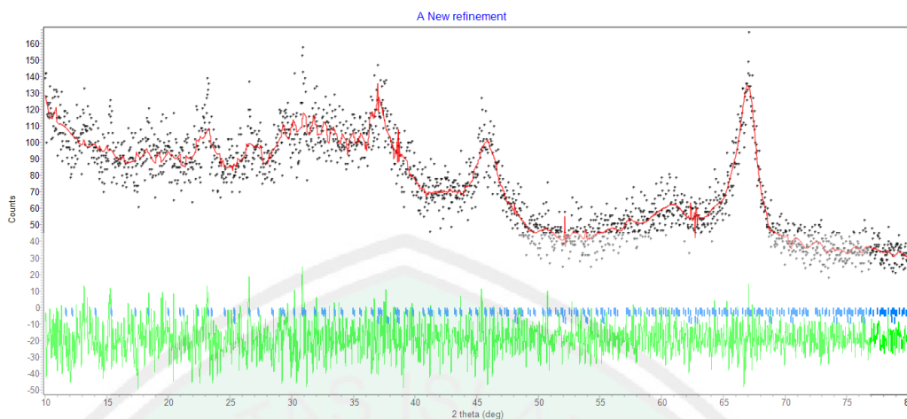
Gambar L.4.8 Plot hasil refinement 5% TiO 2 -V/NaX mesopori
