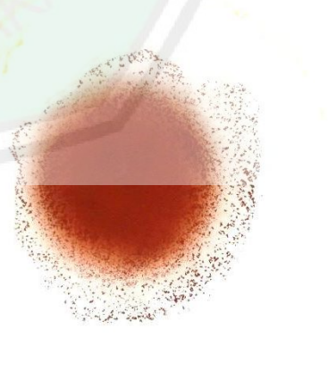
Gambar L.11.6 Endapan merah yang terbentuk pada uji keberadaan \text{Fe}^{3+}
