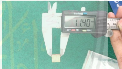
Gambar L.11.22 Pengukuran panjang kayu dengan jangka sorong
