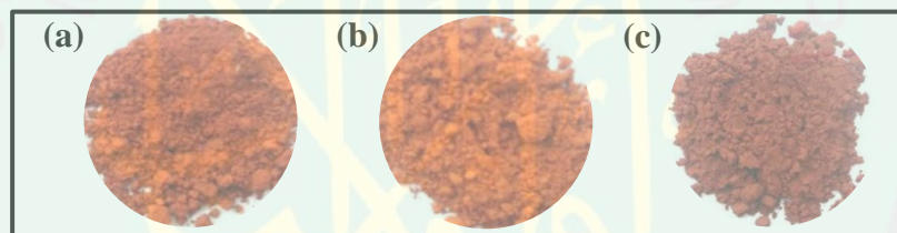
Gambar 4.8 Pigmen hematit hasil sintesis dengan variasi konsentrasi urea sebagai agen pengendap (a) 1 M, (b) 1,5 M, dan (c) 4,5 M urea
