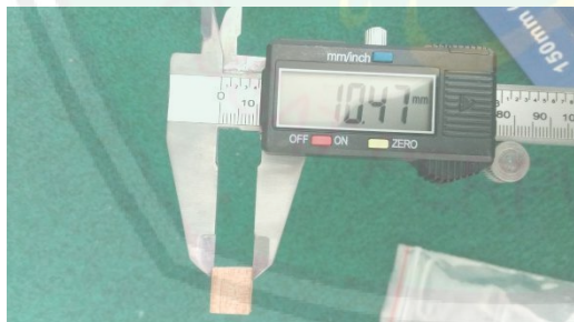
Gambar L.11.23 Pengukuran lebar kayu dengan jangka sorong
