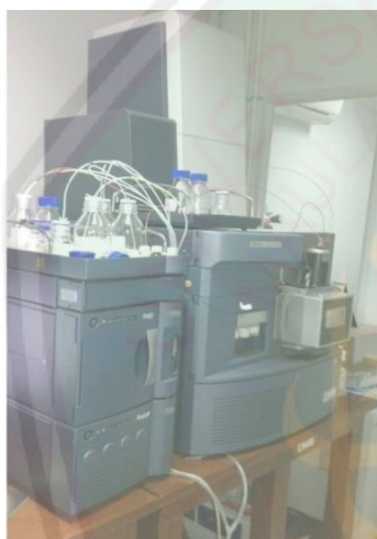
Seperangkat Instrumen UPLC-QToF-MS/MS yang digunakan
