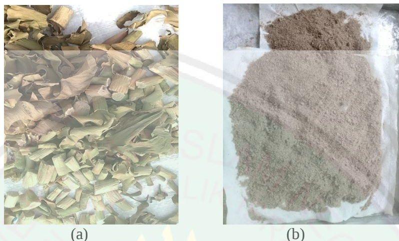
Gambar 4.1 Preparasi biomassa eceng gondok: (a) sebelum digiling, dan (b) sesudah digiling
