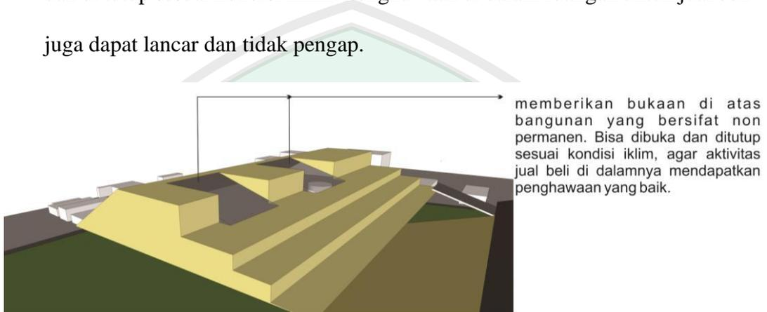
**Gambar 4.23. Membuat Tempat Untuk Ventilasi Yang Dapat Dibuka Dan Di Tutup Sesuai Dengan Kondisi Iklim**
