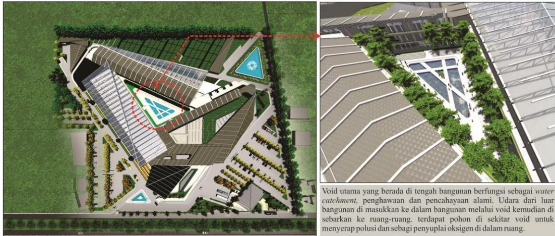
**Gambar 6.14. Void yang Digunakan untuk Memasukkan Angin ke dalam Bangunan**
