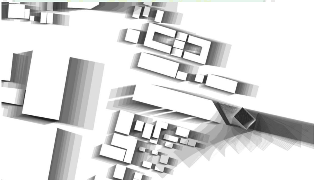
Fig. 4.9.9 Hasil Analisis Dampak Pembayangan Terhadap Bangunan Sekitar (Sumber : Hasil Analisis, 2014)
