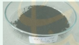
Sampel setelah digerus dan diayak menggunakan 250 mesh
