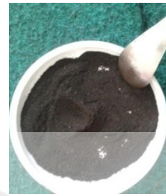
Hasil sampel MnO_2 setelah digerus menggunakan mortar dan alu
