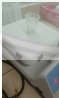
Proses melarutkan PVDF yang ditambahkan dengan DMSO
