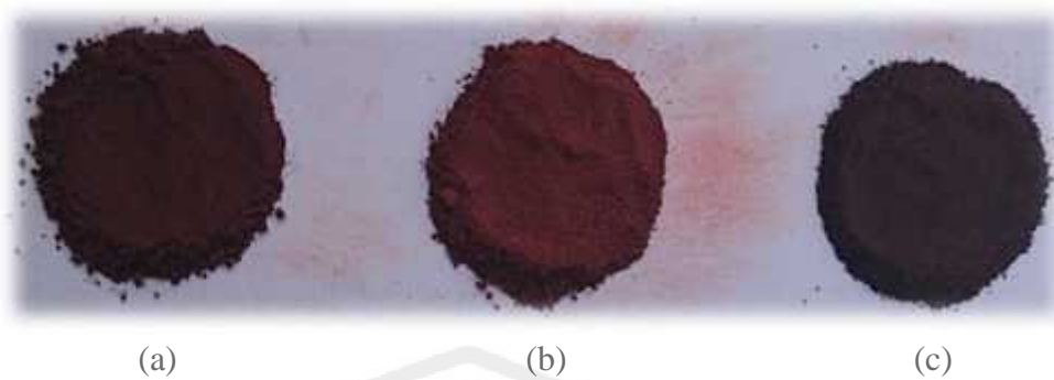
Gambar 4.7 Hasil sintesis pigmen Maghemit menggunakan variasi prekursor (a) \text{FeCl}_2 : \text{Fe}(\text{NO}_3)_3 , (b) \text{FeSO}_4 : \text{Fe}(\text{NO}_3)_3 , (c) \text{FeSO}_4 : \text{FeCl}_3
