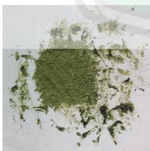
Hasil impregnasi ekstrak hasil fraksinasi: zeolit NaX (5:10)
