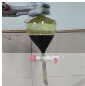
Proses partisi dengan diklorometana dan air
