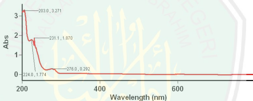
Gambar 4.3 Hasil spektrum sampel kering oven (B)
