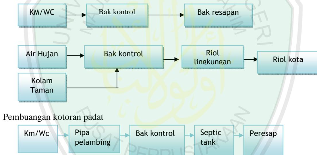
**Gambar 6.18 Konsep pembuangan air kotor**
