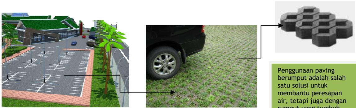
Penggunaan paving berumput adalah salah satu solusi untuk membantu peresapan air, tetapi juga dengan rumput yang tumbuh bisa membantu mengurangi karbondioksida di udara.
