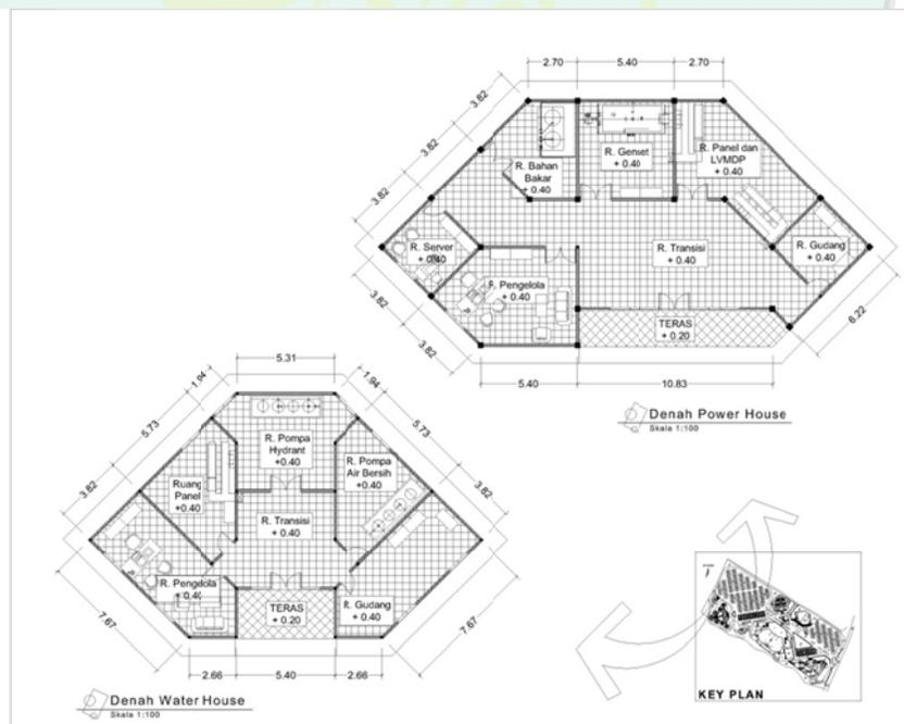
**Gambar 6.35 Susunan Ruang Bangunan Mekanikal Elektrikal**
