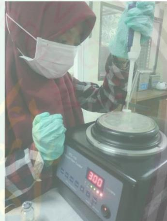
Pelapisan Membran menggunakan Teknik Spin Coating
