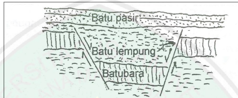
Gambar 2.6 Bentuk Fault (Sukandarumidi, 2006).
