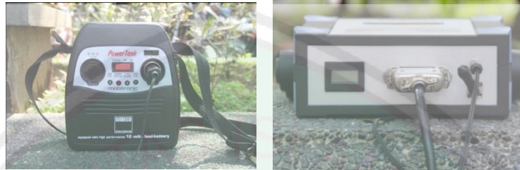
Gambar 4.4 Power Tank dihubungkan dengan Control Unit melalui kabel
