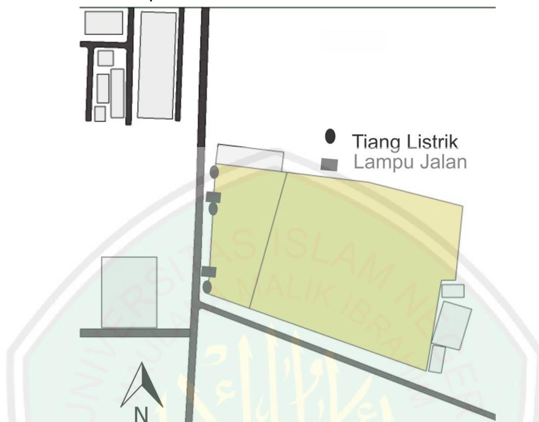
Gambar 4. 13 Penempatan Tiang Listrik dan Lampu Jalan Pada Eksisting Tapak
