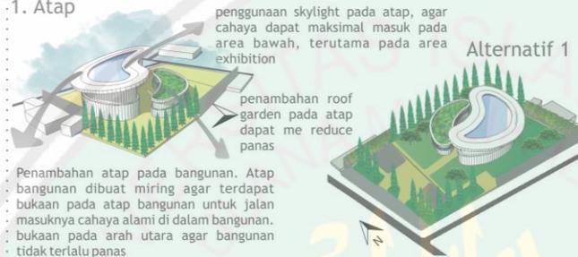
Penambahan atap pada bangunan. Atap bangunan dibuat miring agar terdapat bukaan pada atap bangunan untuk jalan masuknya cahaya alami di dalam bangunan. bukaan pada arah utara agar bangunan tidak terlalu panas
