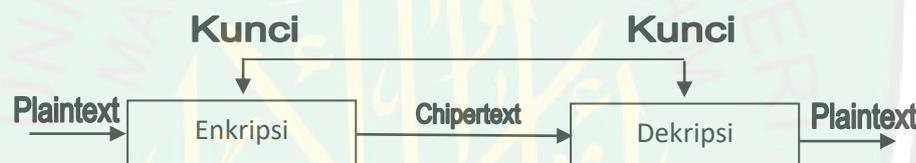
Gambar 2.1 Skema Algoritma Simetri
