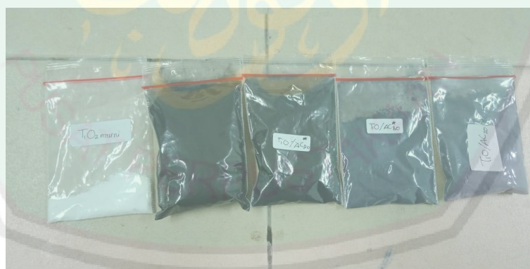
Gambar 4.2 Hasil \text{TiO}_2 /karbon aktif menggunakan metode sol-gel (a) \text{TiO}_2 (b) \text{TiO}_2 /AC95 (c) \text{TiO}_2 /AC90 (d) \text{TiO}_2 /AC80 (e) \text{TiO}_2 /AC70
