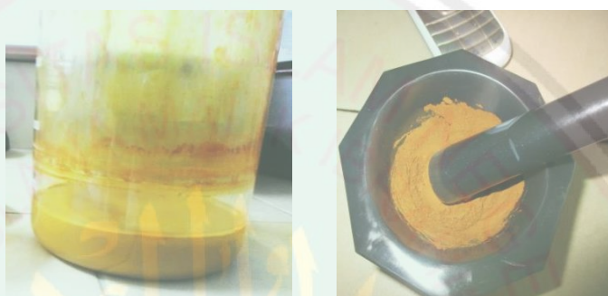
endapan FeOOH serbuk FeOOH Gambar 4.4 Endapan FeOOH dan serbuk FeOOH
