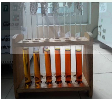
Gambar 4. Pembuatan kurva standar
