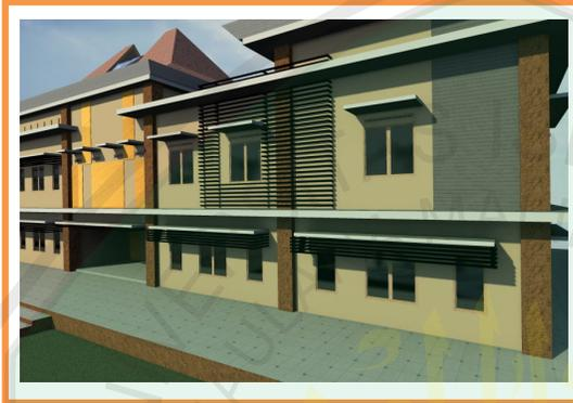
Bangunan ini memiliki ketinggian satu lantai dan dua lantai dengan menggunakan struktur rangka beton pada kolom dan balok dindingnya.
