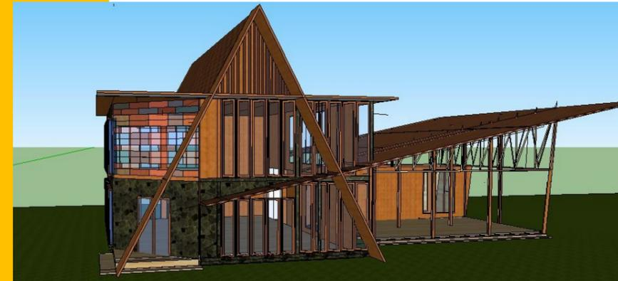
Menggunakan atap pelanadengan tampilan bangunan dari material bambu yang diajar dengan celah-celah diantaranya yang berfungsi untuk memasuukan angin dan matahari.
