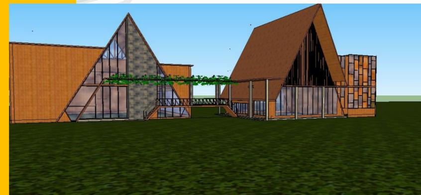
Menggunakan atap bangunan perisai dengan meneruskan hingga kebawah pata tampak depan, dan membuka bangunan pada area tengah untuk memasukkan angin kedalam bangunan, serta membuka bangunan pada area sisi timur.
