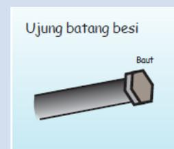
8. Pecahkan buku bagian bambu dengan menggunakan batang besi. Pastikan buku paling ujung tidak ikut pecah.
