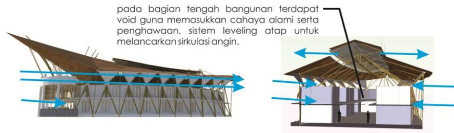
bentuk bangunan menampilkan bambu sebagai struktur kolom yang mengangga atap yang mana penggunaan bambu dikombinasikan dengan baja supaya lebih modern. untuk bentuk atap, bangunan ini mentransformasi bentukan atap pelana dengan material bambu sebagai elemen pendukung bangunan. sehingga tercipta tampilan yang menarik.
