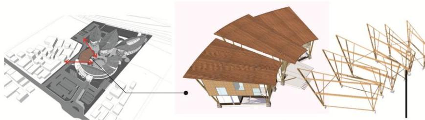
bambu petung digunakan sebagai kolom yang menyerupai bentuk v untuk menahan beban lantai dan atap. sambungan menggunakan baut pada setiap pertemuan
