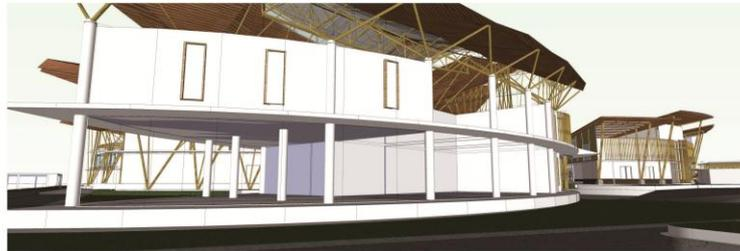
bangunan ini sengaja didesain memiliki banyak bukaan tanpa dinding karena mengingat area pengawetan membutuhkan space yang luas. material dinding menggunakan sistem bambu plestered wall yang memungkinkan dinding berukuran lebih tipis dibanding dengan dinding bata
