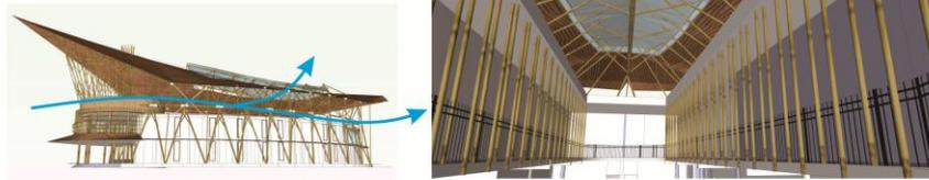
pada lantai 1 terdapat void yang menghubungkan lantai 1 dengan atasnya karena merupakan gallery tanaman, ruang didesain tanpa plafon sehingga bambu di ekspose sebagai struktur atap, serta atap pada bagian tengah panel fiber transparan untuk memasukkan cahaya kedalam bangunan.
