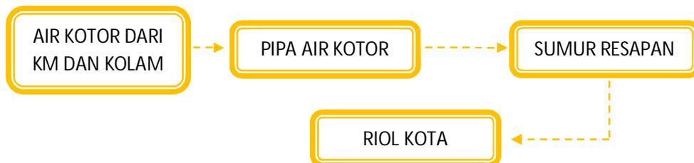
**Skema 6.4 Sistem pembuangan air kotor**
