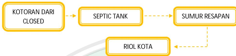
**Skema 6.5 Sistem pembuangan kotoran**
