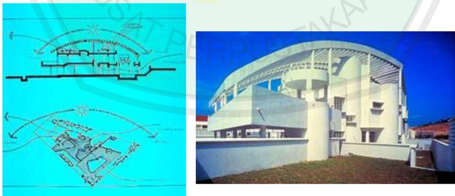
**Gambar 2.11** Orientasi bangunan, Pencegah radiasi matahari dan atap ganda
