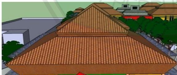
Tampilan atap mengadopsi dari bentukan candi yakni menggunakan atap berbentuk limasan bertumpuk semakin ke atas
