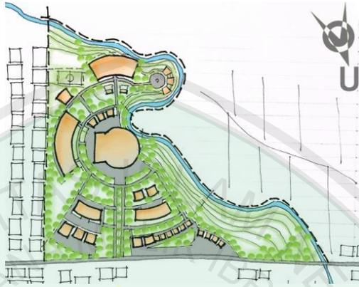
Gambar 4.101 Pola Penataan Massa yang Memungkinkan Bentuk Dasar Bangunan Bundar dan Melengkung
