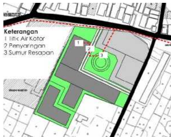
Gambar 4.16 Sistem Pembuangan Air Kotor Dari Dapur Kantin (Sumber : Hasil Analisis. 2012)
