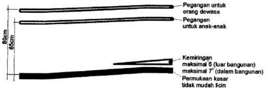
Gambar 2.17 Handrail (Sumber: Departemen Pekerjaan Umum, 1998)
