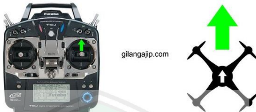
Gambar 2.7. Fungsi Pitch Elevator untuk maju ke depan.
