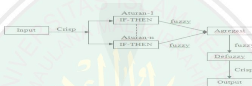
Gambar 2.14. Diagram Blok Sistem Inferensi Fuzzy .
