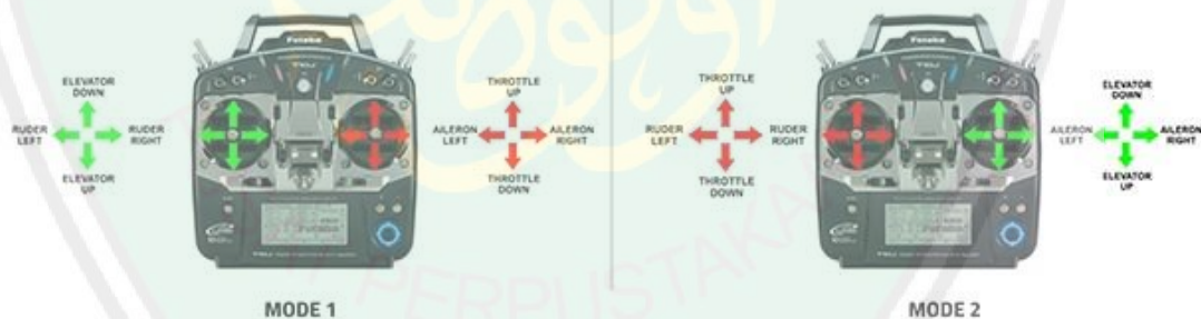
Gambar 2.2. Perbedaan transmitter mode 1 dan mode 2
