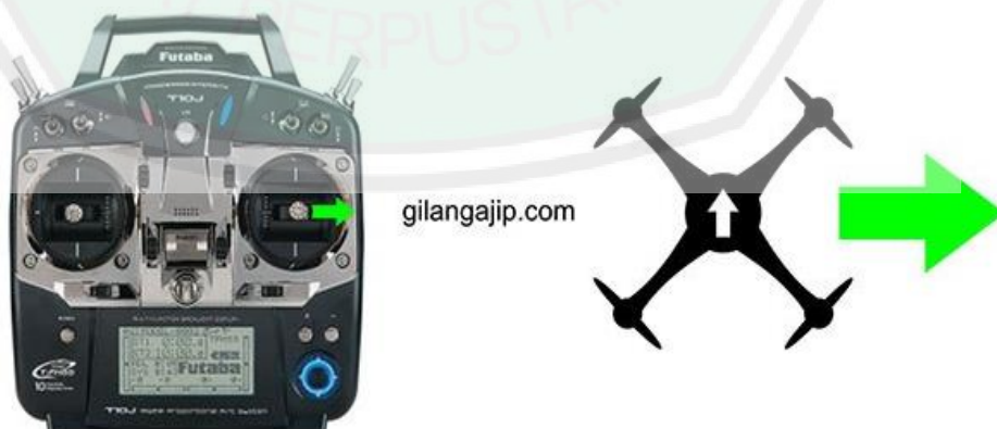
Gambar 2.9. Fungsi Roll ke arah samping kanan.
