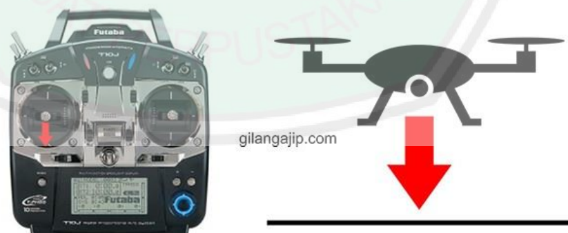
Gambar 2.4. Fungsi throttle untuk turun ke bawah.
