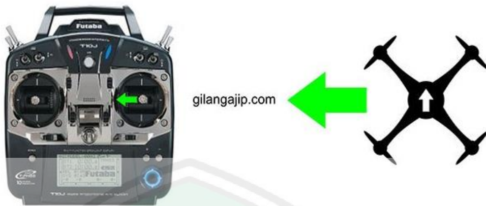
Gambar 2.10. Fungsi Roll ke arah samping kiri.
