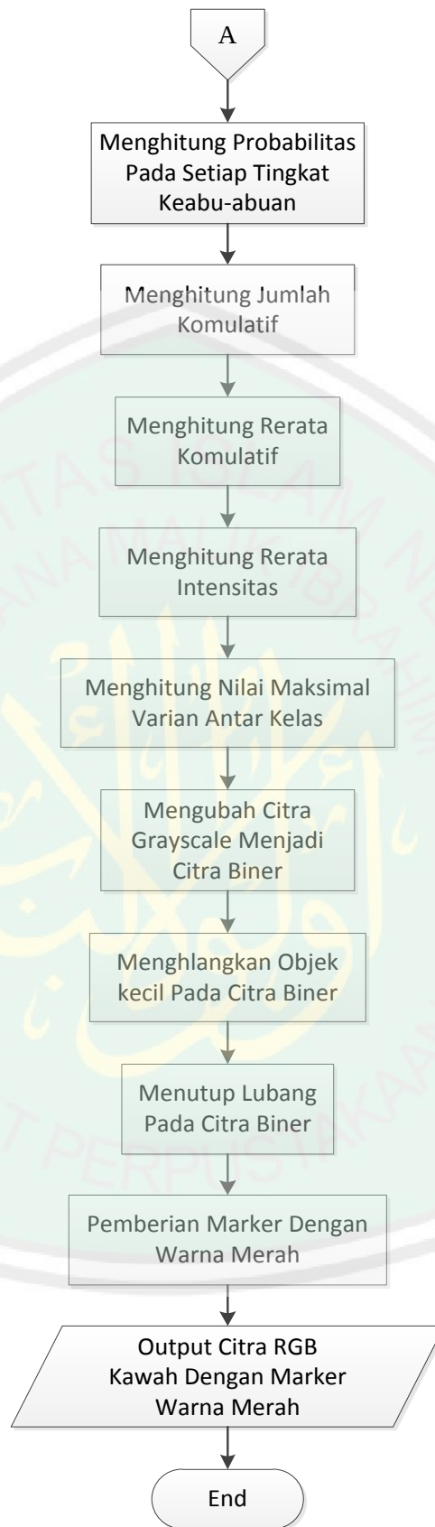
Gambar 3.1 Flowchart deteksi asap
