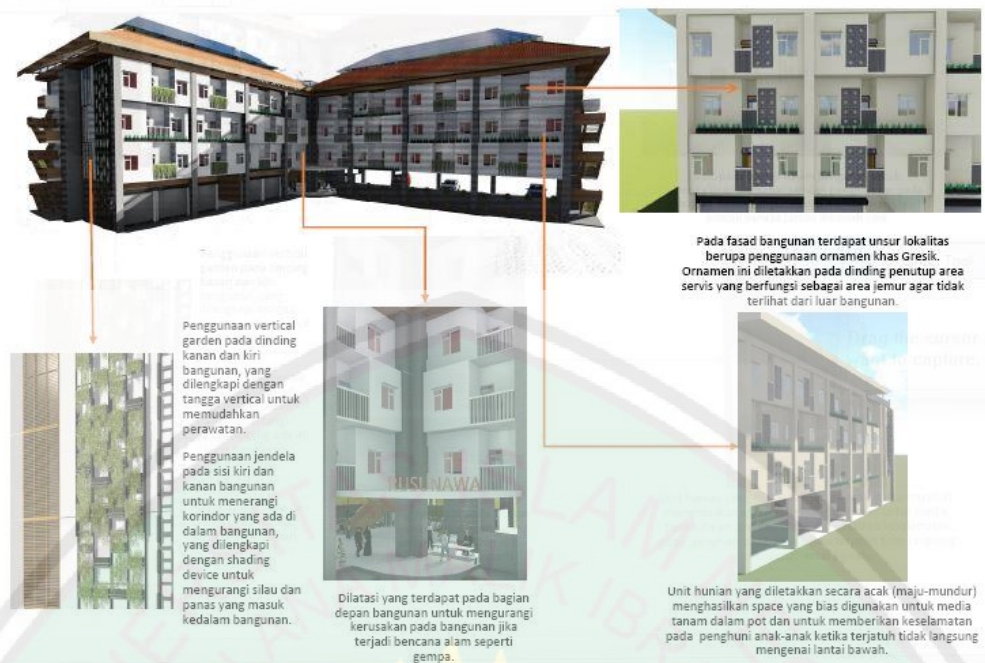
Gambar 7.25. Detail Arsitektural Sumber: Hasil rancangan, 2018
