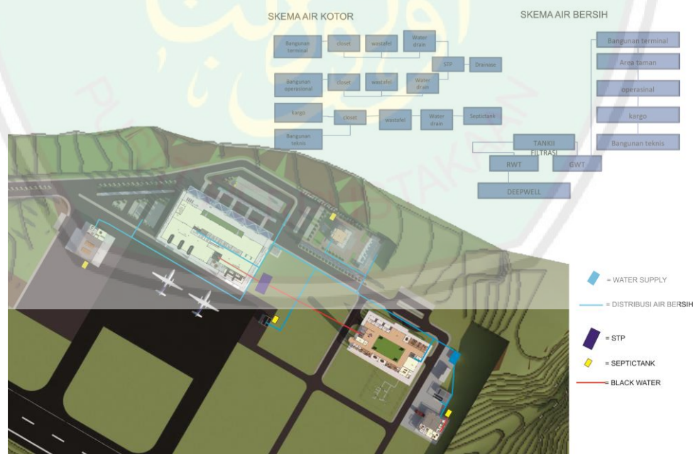
Gambar 7. 15 Utilitas Air bersih dan Air Kotor (Hasil rancangan, 2018).
