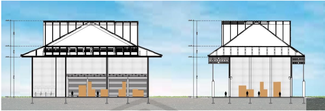
Gambar 7. 33 Potongan Kargo (hasil rancangan, 2018)
