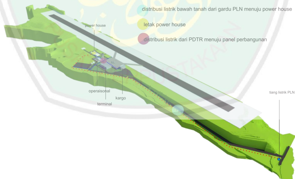
Gambar 5. 29 Analisis Utilitas Elektrikal (hasil analisis, 2017).
