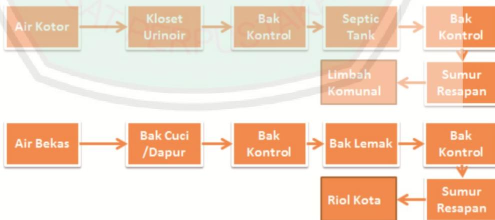
Gambar 5.45. Sirkulasi dan skema plumbing air kotor
